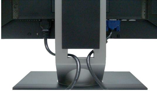
Dopo aver fissato tutti i cavi al monitor e al computer, (Si veda [Collegamento del Monitor](#) per i collegamenti dei cavi,) usare il passacavi per organizzare i cavi in maniera ordinata, come mostrato sopra.
